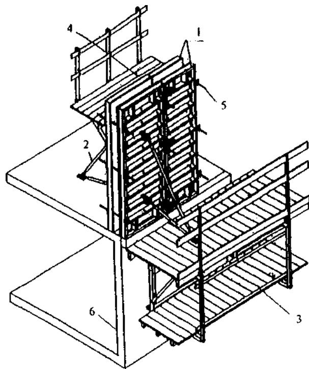
1 — щит; 2 — подкос; 3 — наружные подмости; 4 — подмости для бетонирования;
