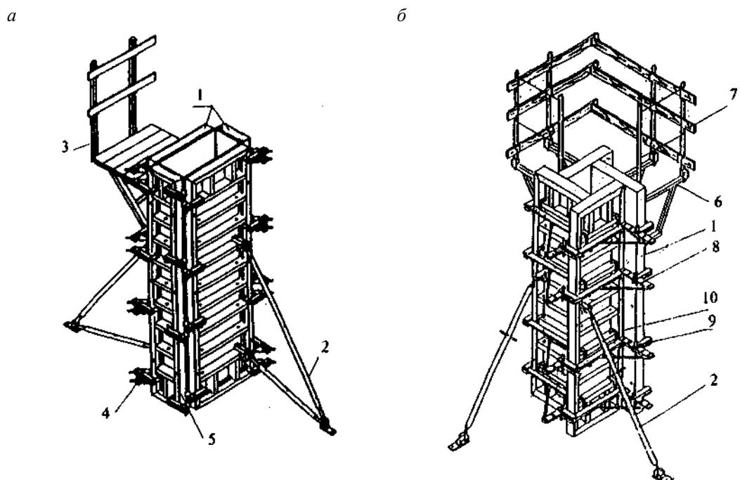
*a* — опалубка колонн (на замках)\*; *б* — опалубка колонн (на хомутах)
