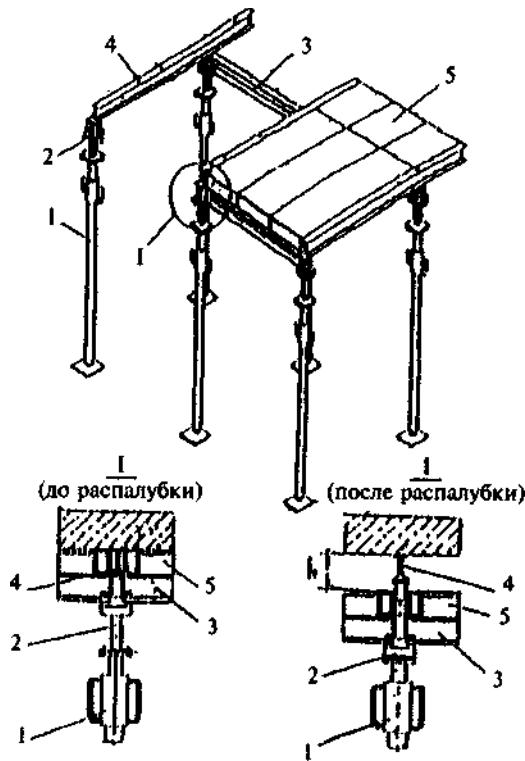
1 — стойка телескопическая; 2 — падающая головка; 3 — балка; 4 — промежуточная опора, остающаяся на бетоне после распалубки (балка, как на рисунке или опора в виде пластины);
