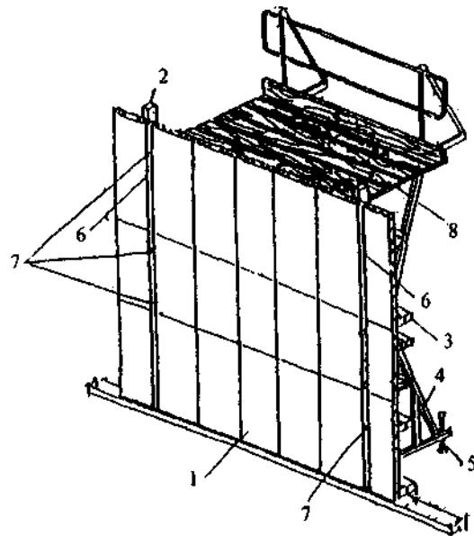
1 — щит; 2 — вертикальная балка; 3 — схватка; 4 — подкос; 5 — домкрат; 6 — деревянная вставка; 7 — отверстие для пропуска стяжки; 8 — подмости для бетонирования
