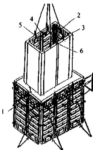
1 — щит внешнего контура; 2 — щит внутреннего контура; 3 — щит угловой внутренний;
