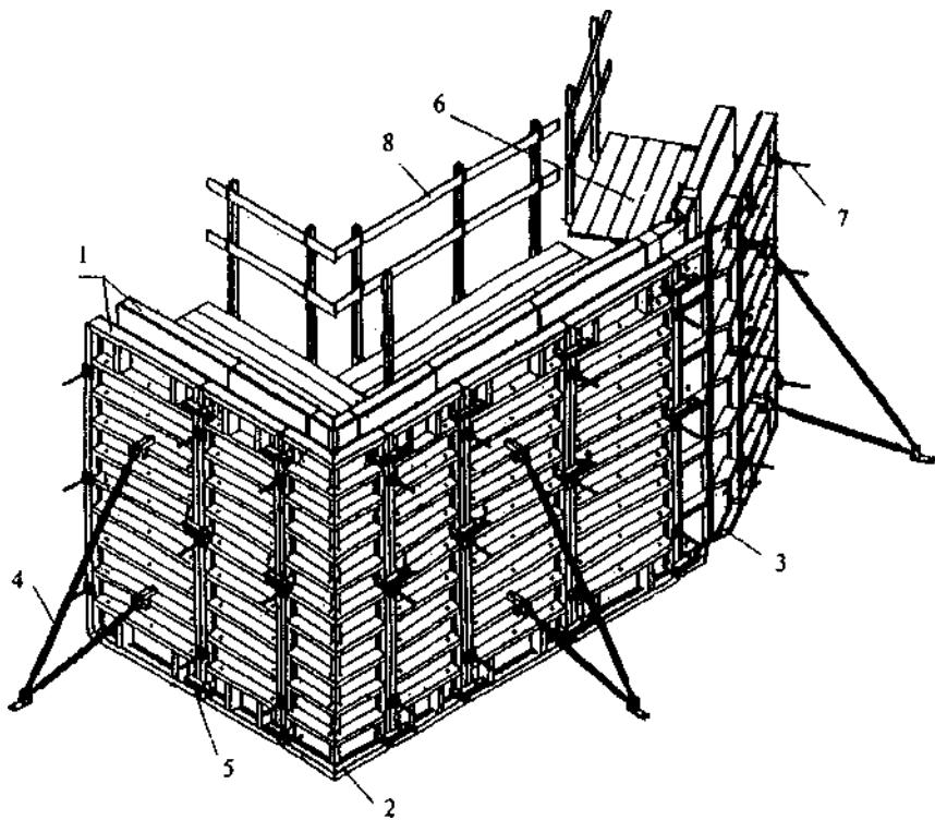
1 — щит; 2 — угловой щит; 3 — шарнирный угловой щит; 4 — подкос; 5 — замок соединения щитов; 6 — подмости для бетонирования; 7 — стяжка; 8 — ограждение
