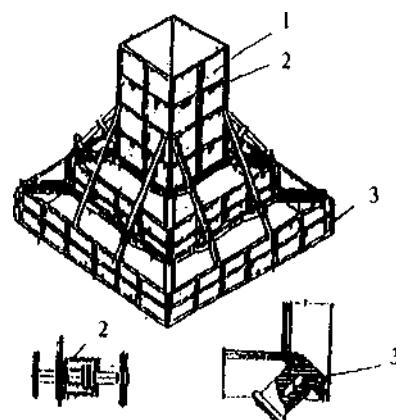
1 — панель; 2 — отжимное устройство; 3 — замок
