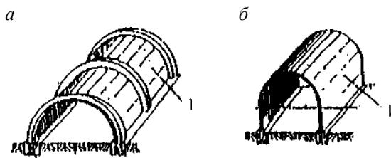
*a* — ребристый цилиндрический свод; *б* — гладкая цилиндрическая сводчатая оболочка с вертикальными стенами
