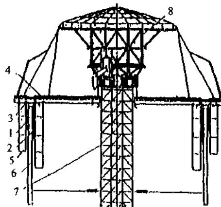
1 — щит наружной опалубки; 2 — щит внутренней опалубки; 3 — механизм радиального
