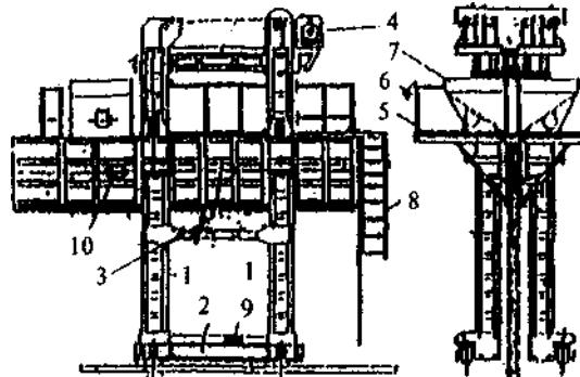
1 — стойка тележки; 2 — тележка; 3 — щит; 4 — устройство подъема щитов; 5 — подмости
