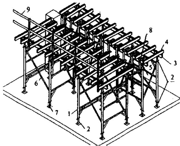
1 — рама; 2 — домкрат; 3 — продольная балка; 4 — поперечная балка; 5 — опора балки (вилка); 6 — монтажная связь рам; 7 — основание рамы; 8 — струбцина балки;
