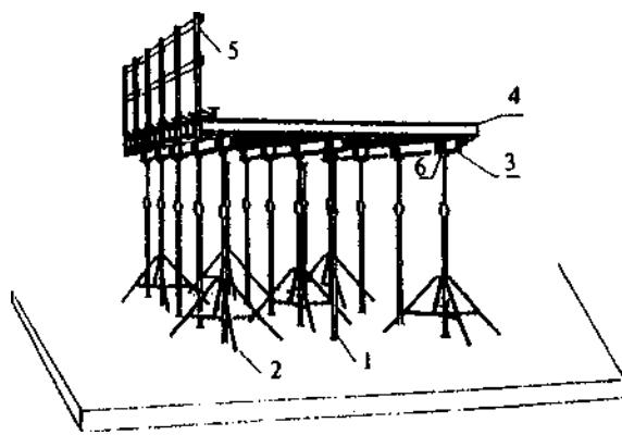
1 — стойка телескопическая; 2 — тренога; 3 — продольная балка; 4 — поперечная балка;
